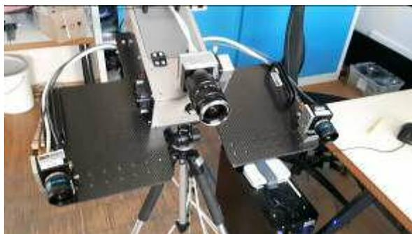
**Abb. E.6:** Neue mechanische Aufhängung des Messaufbaues.
