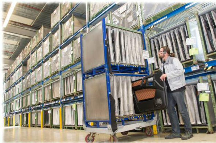
**Abb. B.2:** Sprachgesteuerte Kommissionierung im Einsatz in der Industrie, entstanden aus Studierenden-Projekt im Knowledge Work Lab 2020
