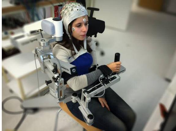
**Abb. D.1:** Die Armbewegungen einer Testperson während einer EEG Messung werden mittels Armeo Spring gemessen und unterstützt.
