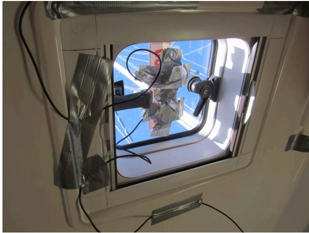
Befestigung des Beschleunigungs-/GPS-Sensors
