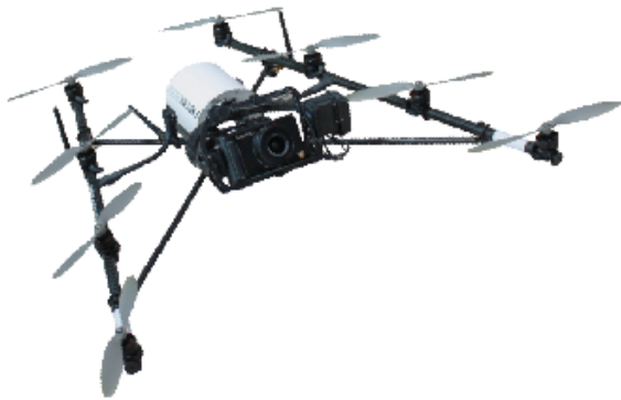
Abb. E. 4: Octocopter Falcon 8 mit stärkeren Motoren der höhere Flughöhen zulässt und gleichzeitig das aus 2 GoPro Hero Kamera bestehende Stereo-Kamera Setup tragen kann.
