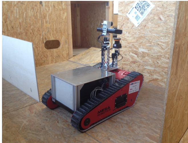
Abb. F. 5: Rettungsroboter mit neuer Rechneinheit
