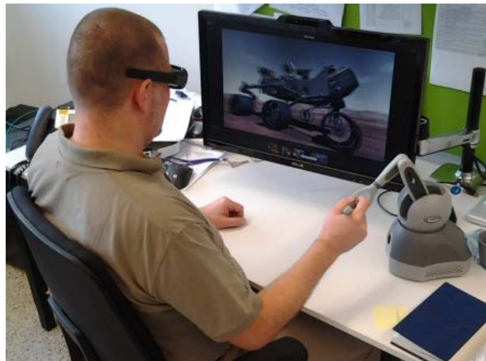
Abb. D. 7: Ein Benutzer bedient mit der rechten Hand das Geomagic Touch und erhält haptisches Feedback. Am 3-D Bildschirm wird ein Model des Mars Rovers dargestellt.
