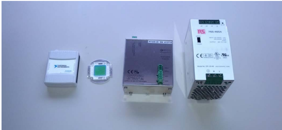
Abb. E. 6: V.I.n.r. Digital I/O, 100W LED, Blitzsteuerung, Stromversorgung als Komponenten der getriggerten und synchronisierten Projektor-Lichtquelle.
