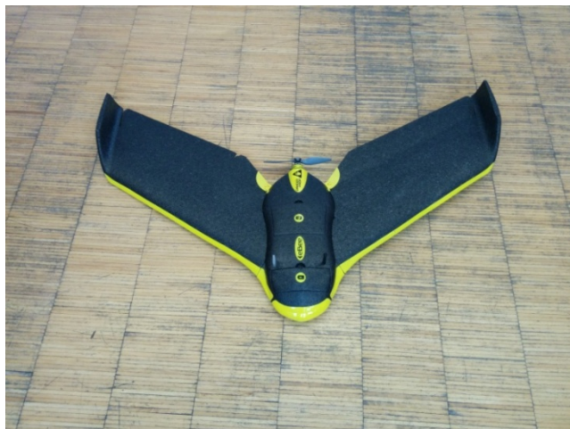
Abb. E. 1: Sensefly Ebee – unbemanntes Luftfahrzeug zur autonomen Aufnahme von hochauflösenden Luftbildern
