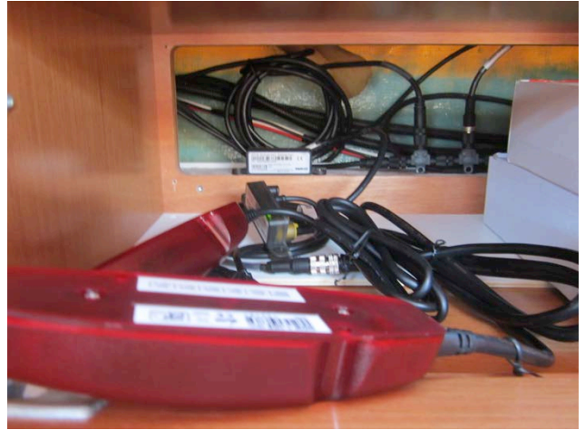
Anbindung an den NMEA-Bus im Segelschiff
