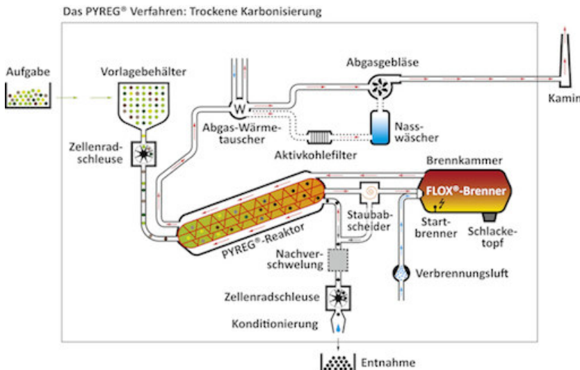
Abb. 3: Schema des Pyregverfahrens [7]
